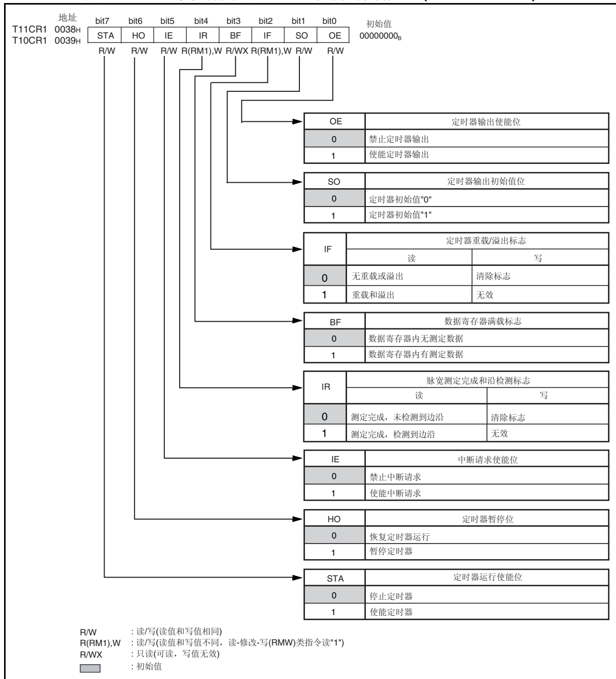
图 14.5-6 8/16 位多功能定时器 10/11 状态控制寄存器 1 (T10CR1/T11CR1)
